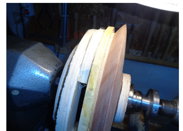
Incollaggio primo cerchio
