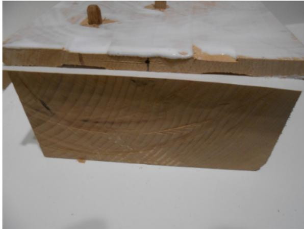
una volta asciugata la colla bisogna fare due fori ( per la mia coda di porco da 8mm) uno lungo vena e uno trasverso
