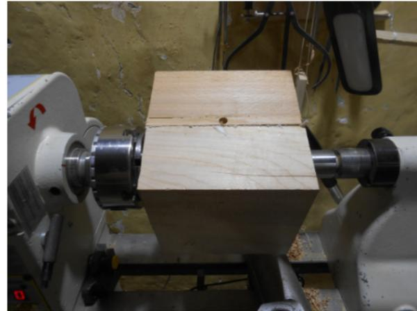
si cilindra normalmente utilizzando una sgorbia da sgrossa, (consiglio vivamente in questo frangente l'uso della visiera di protezione e di verificare spesso la tenuta della colla) attenzione a mantenere le quote verificando con un compasso da esterni, se necessario eseguire la carteggiatura
