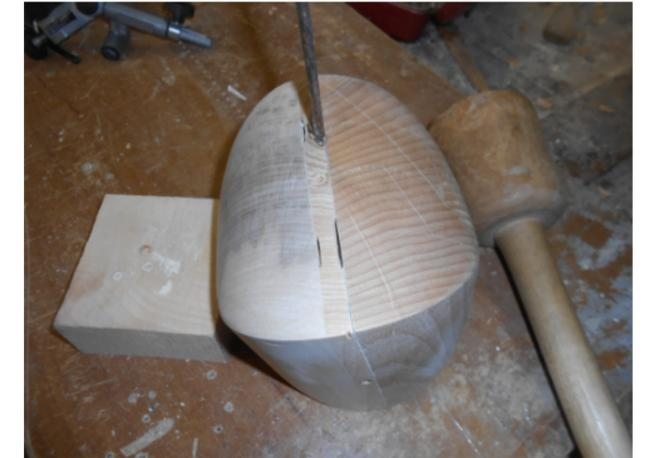
si monta una ciotola sulla coda di porco utilizzando il foro centrale, per il terzo asse di tornitura, al fine di poter eseguire la presa mandrino
