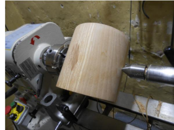
si fa girare il tornio per il secondo asse di tornitura e si cilindra verificando il diametro con il compasso da esterno mantenendo l'apertura delle punte come quella della cilindratura lungo vena, una volta controllate le quote se necessario si la carteggia
