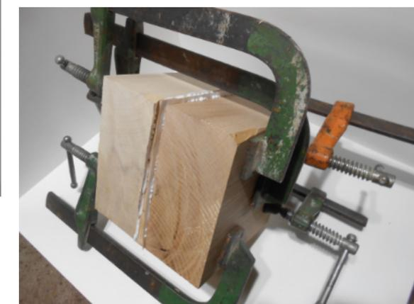
notare che sulla tavoletta da 10 mm sono stati fatti degli scassi per agevolare l'inserimento di uno scalpello, in seguito serviranno aiuteranno nell'operazione di distacco dei pezzi
