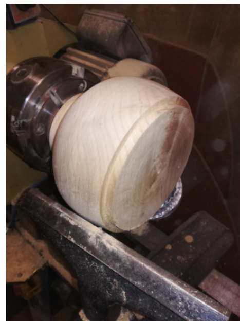
Creiamo al centro il foro del diametro desiderato ( per la bocca del hollow )
