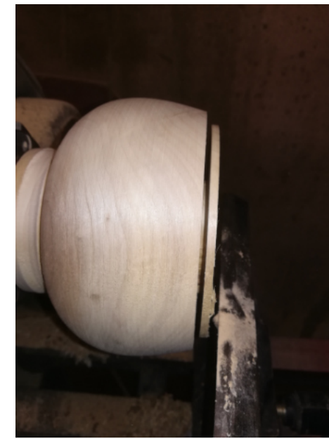
Con un troncatore molto sottile ( 3 mm ) tagliamo il coperchio
