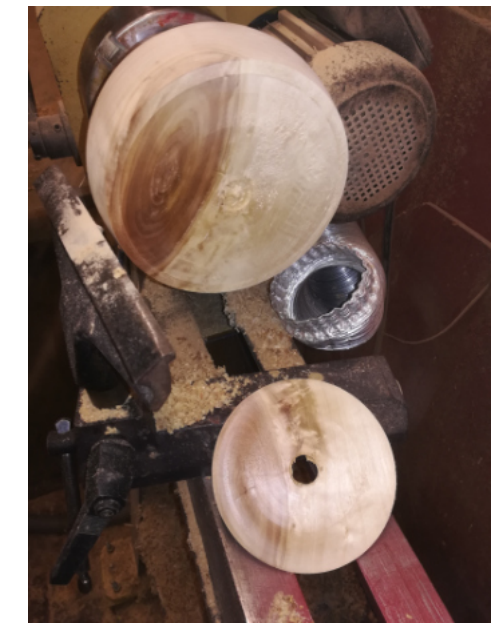
una volta ricavato il coperchio levighiamo la parte interna accuratamente
