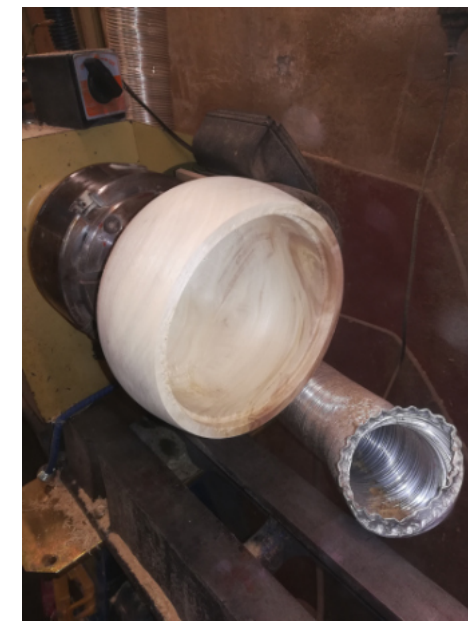
Iniziamo lo scavo creando la sede per il coperchio di circa 3 mm più profonda dello spessore dello stesso
